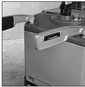
Barras laterales de seguridad acolchadas
